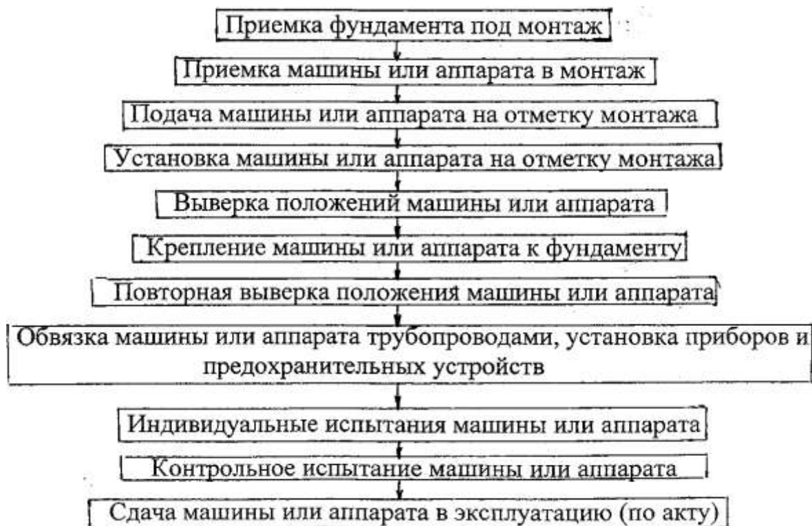
Рисунок 2.5 - Примерная схема монтажа оборудования
